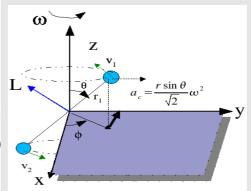
I gradi di libertà sono veramente pochi! Solo uno, basta infatti l'angolo  $\phi$  di rotazione attorno all'asse z verticale per fissare tutto; come dire basta una equazione per conoscerne il moto e visto che non ci sono forze esterne il sistema è destinato a ruotare a velocità costante attorno al suo asse verticale!
