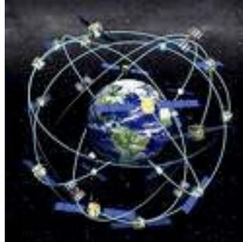
Il principio di funzionamento si basa su un metodo di posizionamento sferico, che consiste nel misurare il tempo impiegato da un segnale radio a percorrere la distanza satellite-ricevitore.
